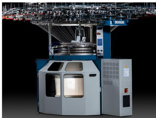
Tradizionale basamento Orizio modulare, rinnovato nella funzionalità, robustezza ed estetica, con nuovo pannello di controllo "Oritec" che permette la fruizione di nuove tecnologie ed ingloba in un'unica scheda elettronica le seguenti funzioni:
